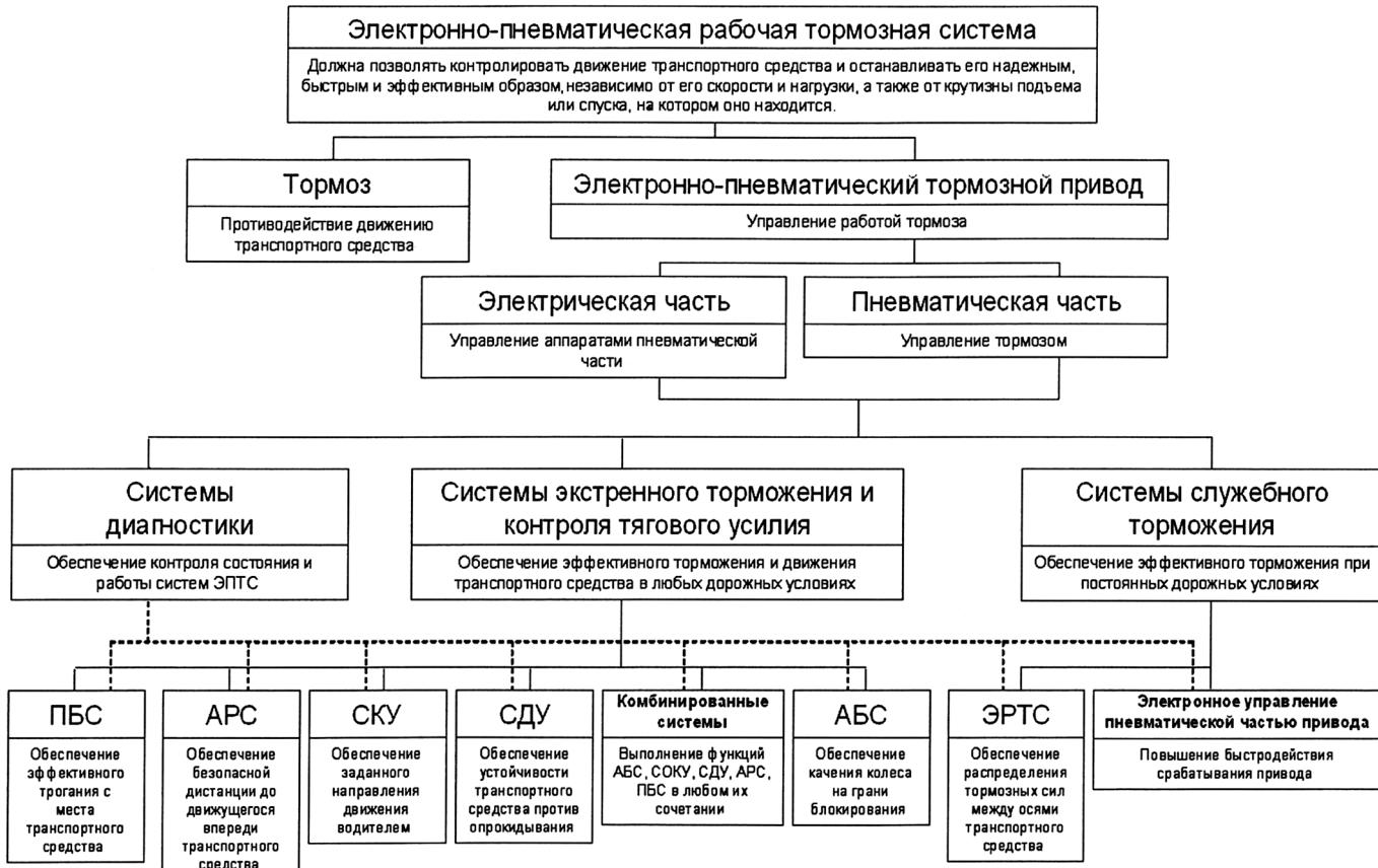
Рис. 1. Функциональная схема ЭПТС
