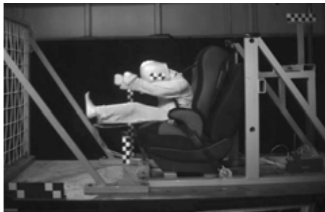
Рис. 2. Фрагмент динамических испытаний ДУС
