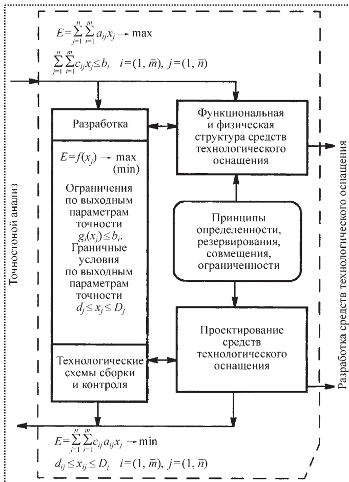
Рис. 1. Структура технологического проектирования в сборочном производстве:
