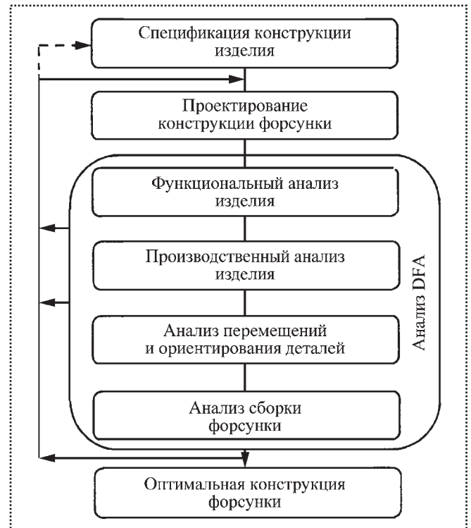
Рис. 1. Последовательность разработки конструкции в системе компьютерно-интегрированного производства и структура метода DFA (на примере форсунки дизельного двигателя)
