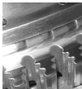
Рис. 8. Состояние торцевой поверхности после обработки абразивно-полимерными щетками
