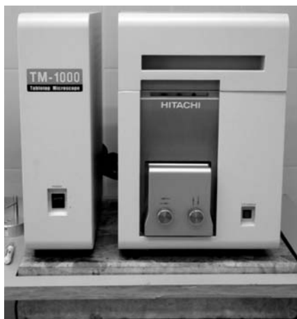
Рис. 2. Сканирующий электронный микроскоп Hitachi TM-1000
