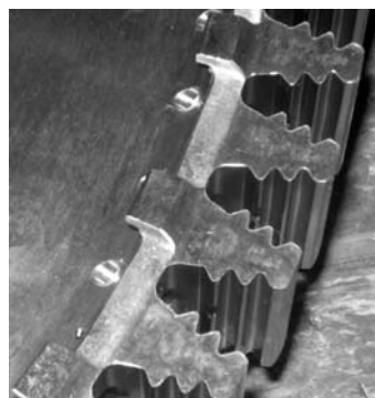
Рис. 2. "Елочные" пазы диска турбины и торцевая поверхность обода после токарной обработки
