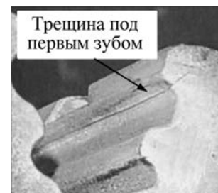
Рис. 3. Типичный характер расположения трещин в "елочном" закреплении лопаток в дисках турбин
