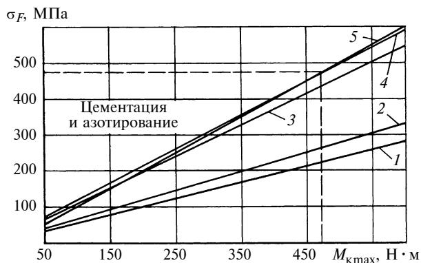
Рис. 5. Зависимости изгибных напряжений в зубьях зубчатых колес (поз. см. рис. 3) от момента сопротивления на кулачковом валу ТНВД:
