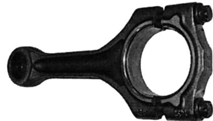
Рис. 2. Шатун со стыком, поверхности которого получены разломом монолита
