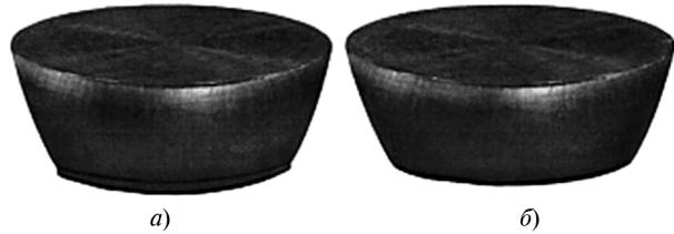
Рис. 5. Типовые образцы из свинца С00, полученные осадкой со смазыванием верхнего торца и фиксацией нижнего в цилиндрическом (а) и коническом (б) углублениях, мм:
