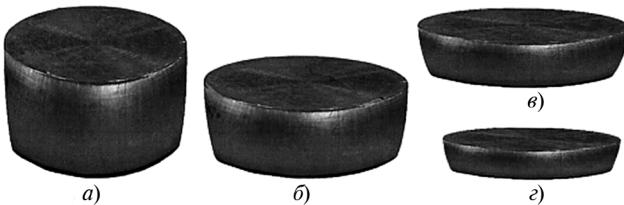
Рис. 3. Типовые образцы из свинца С00, полученные осадкой со смазыванием верхнего торца и обезжириванием нижнего, мм:
