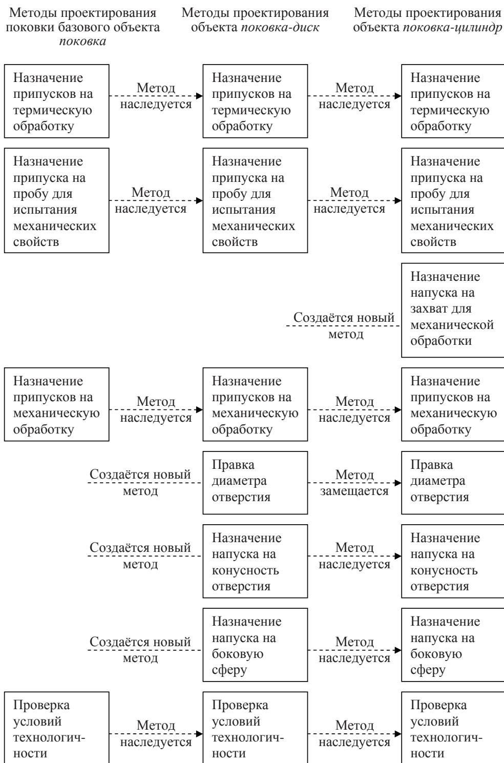
Рис. 1. Наследование методов проектирования поковки объектом *поковка-цилиндр*
