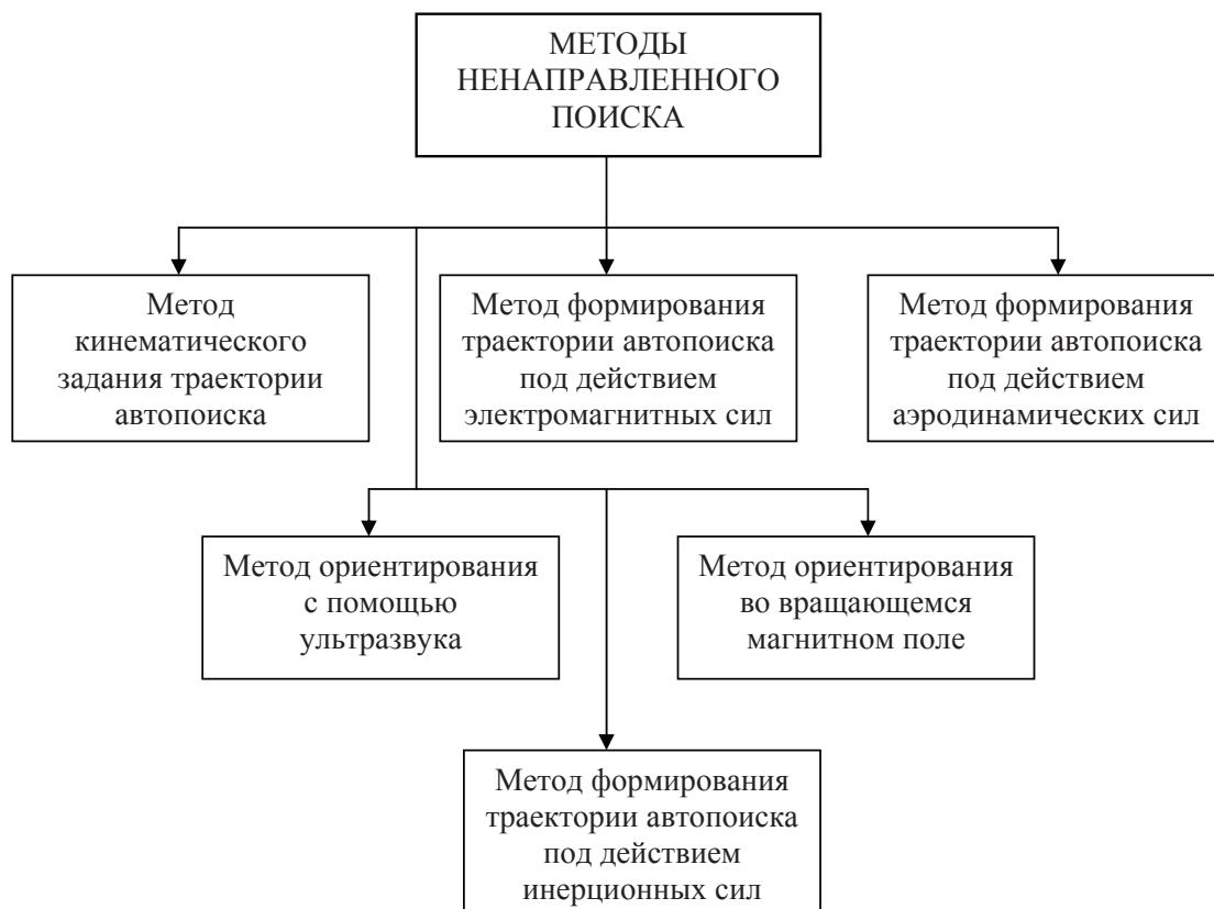
**Рис. 1. Классификация методов адаптации положения соединяемых деталей для автоматизированной сборки путем ненаправленного поиска**
