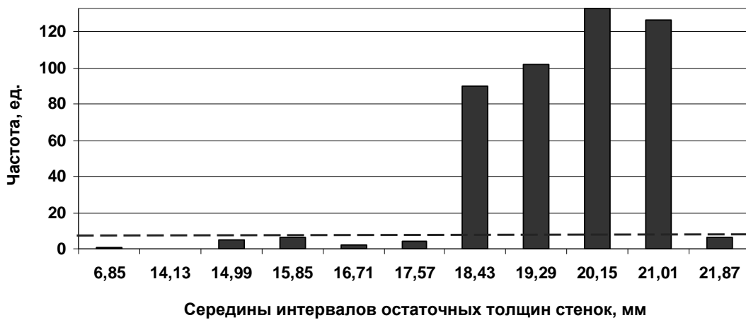
Рис. 5. Гистограмма интегрального распределения аналоговой переменной технологического трубопровода на этапе 27-летней эксплуатации
