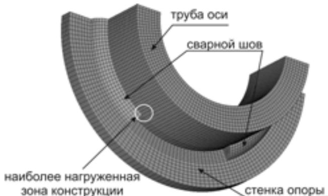
Рис. 4. Конечно-элементная модель фрагмента оси прицепа (подмодель)
