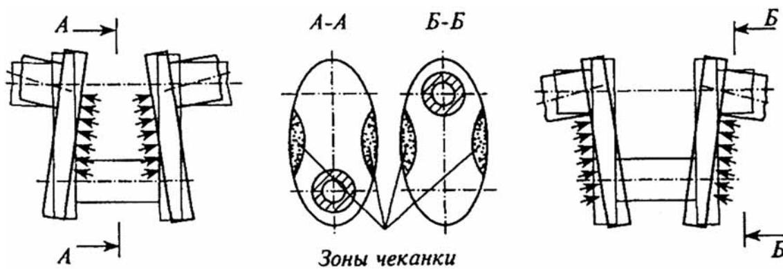
Рис. 2. Правка коленчатого вала наклепом (чеканкой)
