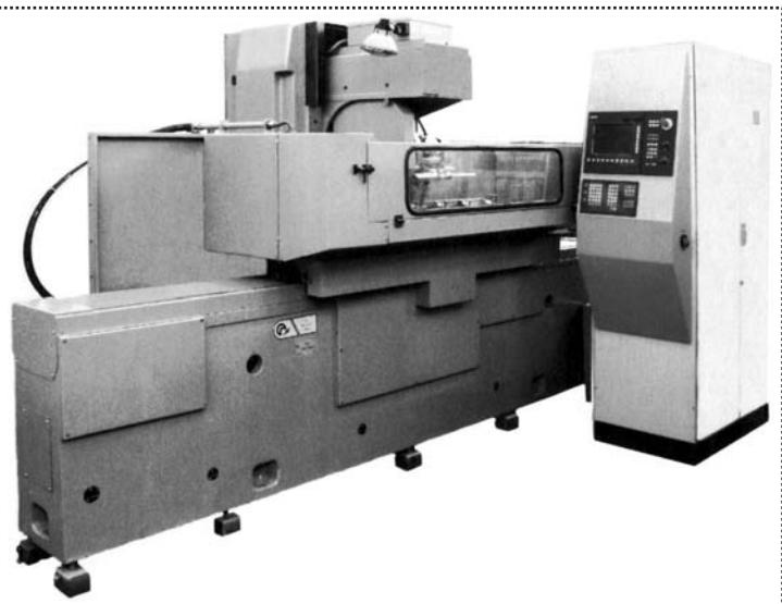
Рис. 1. Рейкошлифовальный станок с ЧПУ мод. МШ428
