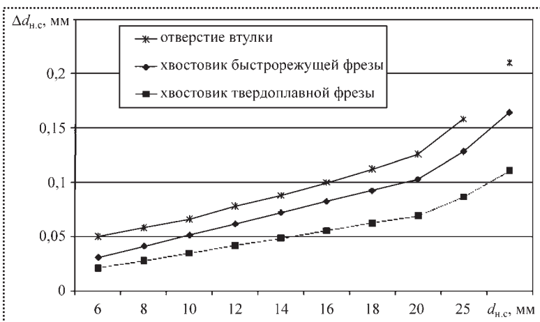
Рис. 2. Зависимости приращений номинального диаметра соединения при нагреве в процессе разборки комплектов
