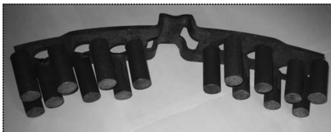
Рис. 2. Стальной каркас биметаллической тормозной колодки
