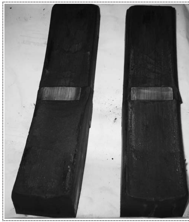
Рис. 4. Тормозная полуметаллическая колодка с чугунной вставкой марки «Фритекс-970/2»
