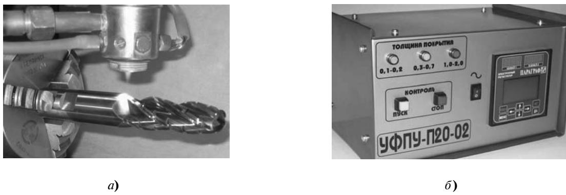
**Рис. 7. Процесс финишного плазменного упрочнения фрезы (а) и прибор контроля нанесения покрытия (б)**
