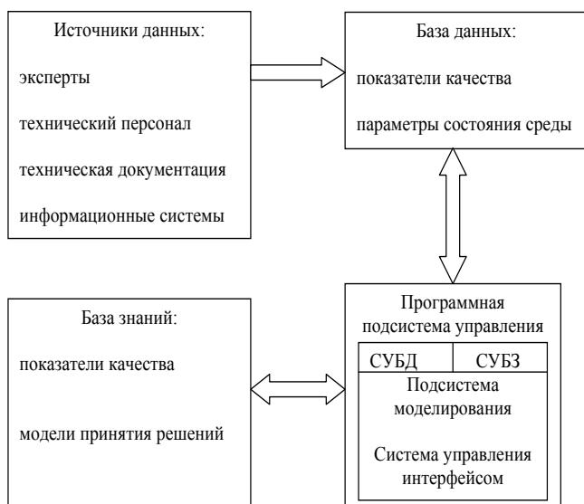
Рис. 2. Система поддержки решений
