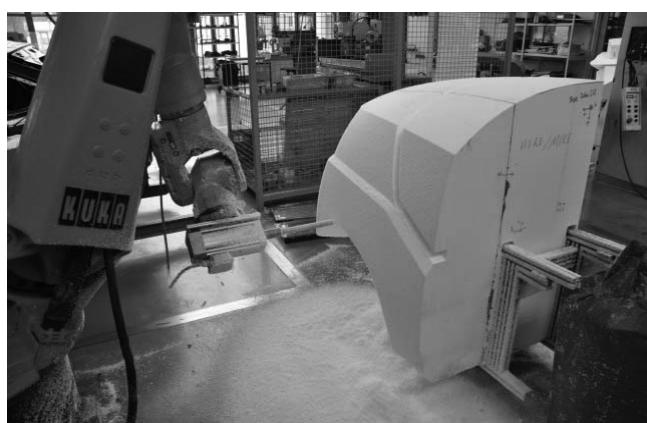
**Рис. 4. Фрезерование пенопласта роботом фирмы KUKA**
