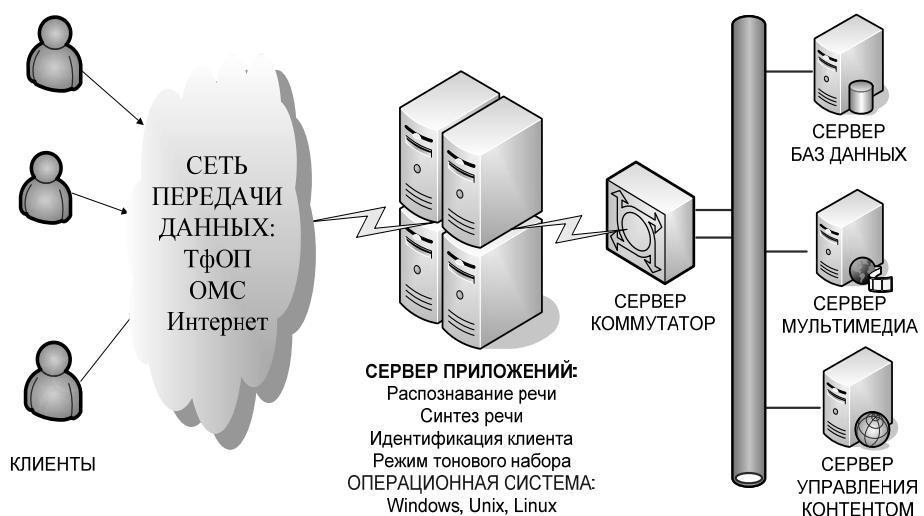
Рис. 3. Архитектура интегрированной системы самообслуживания
