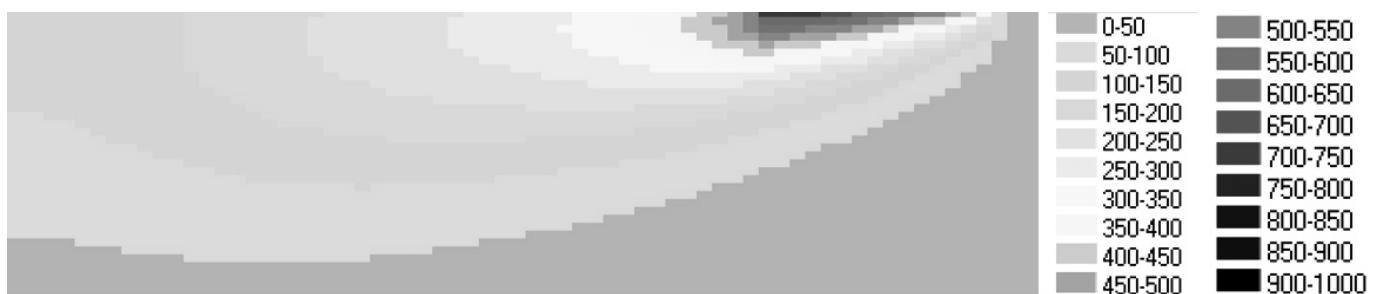
Рис. 2. Расчётное температурное поле при шлифовании титанового сплава ВТ6
