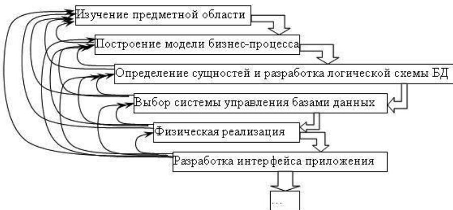
Рис. 1. Итерационная схема разработки информационной системы
