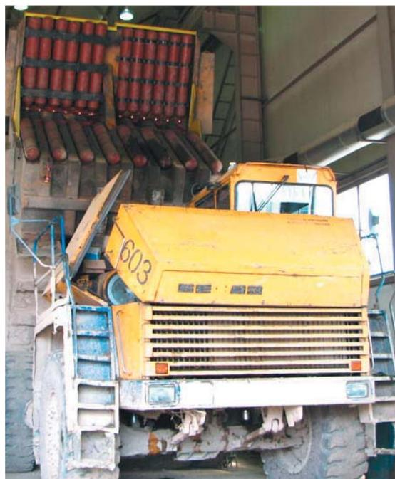
*Дизельный автомобиль, работающий на сжатом газе - метане*
