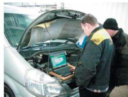
Газовое оборудование автомобилей регулируется с помощью электронного программного комплекса и средств ЭВМ.
