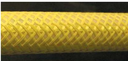
Арамид волокно и обеспечивает всю прочность трубы. Многим знакомы слабые прочностные характеристики (растяжение под нагрузкой) пластика в целом и полиэтилена в отдельности. Арамид волокно имеет врожденные превосходные прочностные характеристики, что подтверждается использованием данного материала в бронежилетах и металлокорде. Продольные волокна минимизируют растяжение, а радиальные волокна обеспечивают прочность на разрыв.
