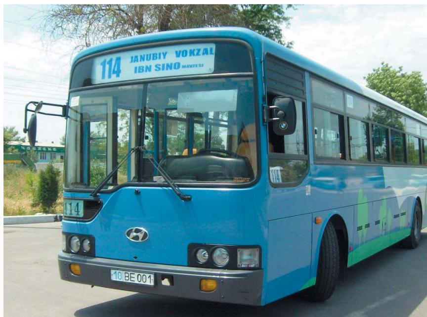
Рис. 1. Автобус HYUNDAI с газовым двигателем С6АВ (ТС1), эксплуатируемый в г.Ташкенте
