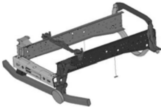
Рис. 4. Модель противоподкатного устройства автомобиля и кривые поглощения энергии его элементами в процессе виртуальных испытаний на удар:
