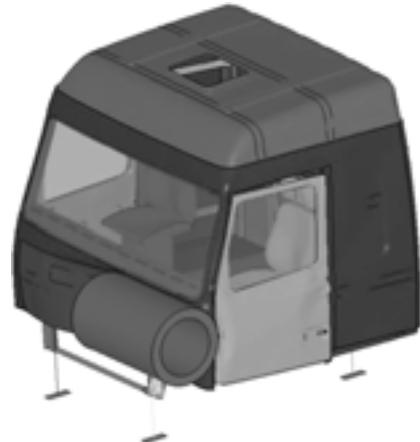
Рис. 1. Виртуальная модель кабины грузового автомобиля, применяемая при испытаниях на удар цилиндрическим маятником по передней ее части
