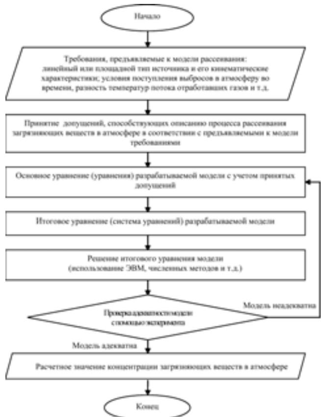
Рис. 2. Алгоритм модели рассеивания составляющих отработавших газов АТС в атмосферном воздухе
