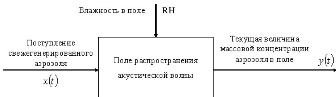
Рис. 3. Математическая модель увлажнения аэрозоля
