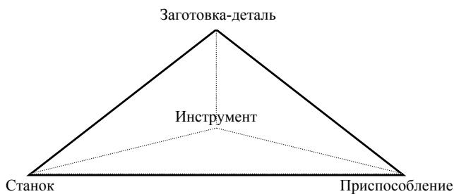
**Рис. 4. Модель взаимодействия технологической системы с заготовкой в производственной среде**
