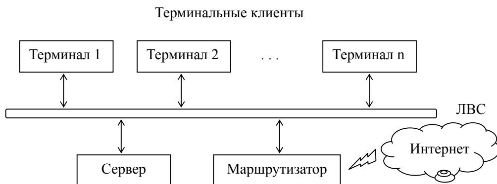
**Рис. 1. Классическая реализация технологии «тонкий клиент» для многопользовательской вычислительной системы**
