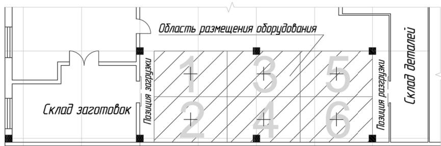
**Рис. 1. Схема расположения рабочих позиций с разделыми позициями загрузки/разгрузки**
