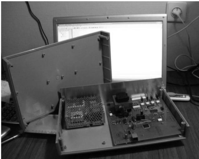
Рис. 8. Регулятор контактной сварки СК-300
