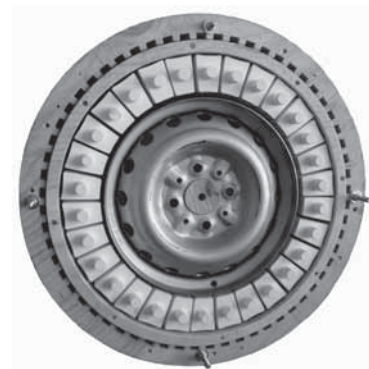
Рис. 4. Стальная литейная матрица для изготовления полиуретановых шин с упругими деформируемыми спицами
