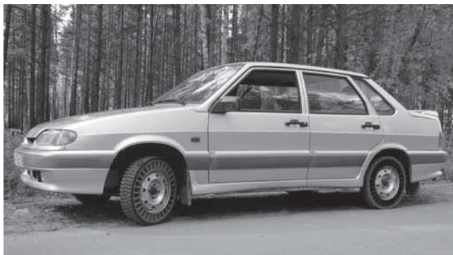
Рис. 2. Автомобиль ВАЗ-2115 на экспериментальных колесах с безвоздушными полиуретановыми шинами
