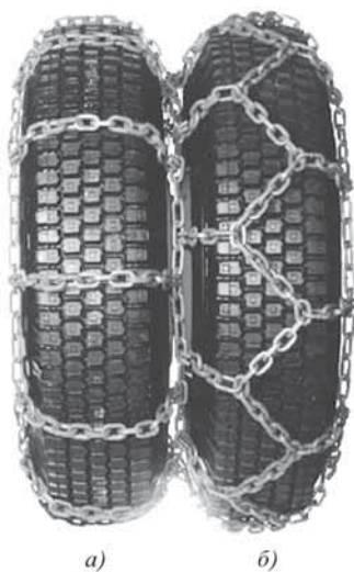
Рис. 1. Цепи противоскольжения с ромбовидным (а) и лестничным (б) плетениями дорожки
