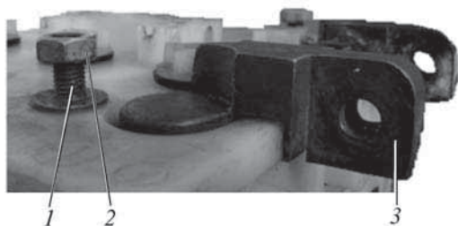
Рис. 3. Комбинированный полюсный вывод батареи-модуля: 1 – шпилька; 2 – гайка; 3 – проушина
