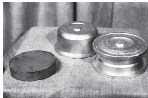
Рис. 3. Заготовка и цельноштампованный диск колеса после первого и второго переходов
