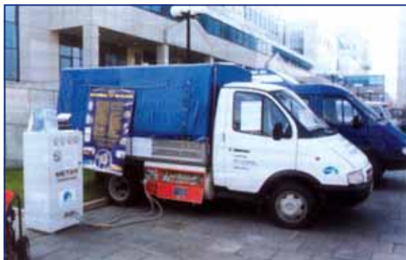
Рис. 1. Общий вид грузового автомобиля "Газель" с СПГ-баком и системой заправки
