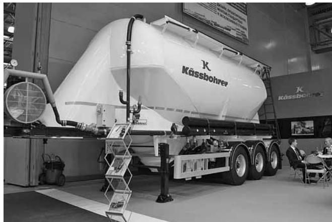
Рис. 4. Цистерна-полуприцеп Kassbohrer SSL30 предназначена для перевозки цемента
