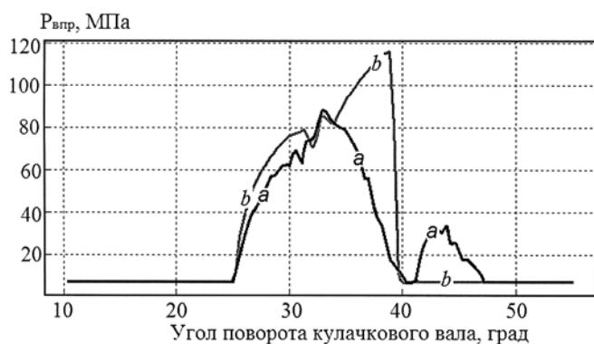
**Рис. 4. Характеристика давления впрыскивания топлива по углу поворота вала ТНВД:**
