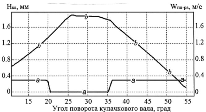
**Рис. 3. Закон движения затвора клапана и зависимость скорости плунжера от угла поворота вала ТНВД:**
