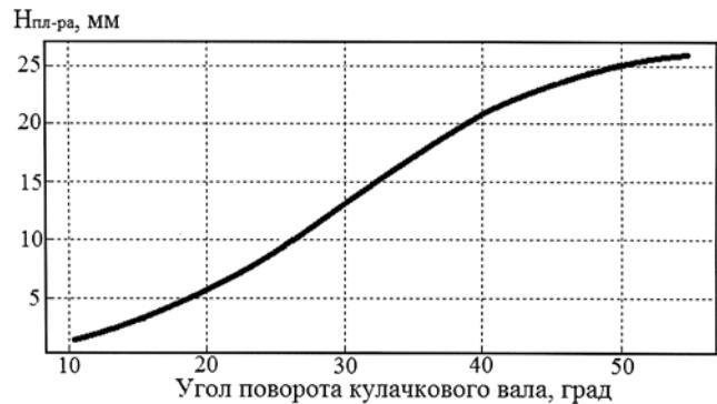
**Рис. 2. График хода плунжера по углу поворота кулачкового вала ТНВД**
