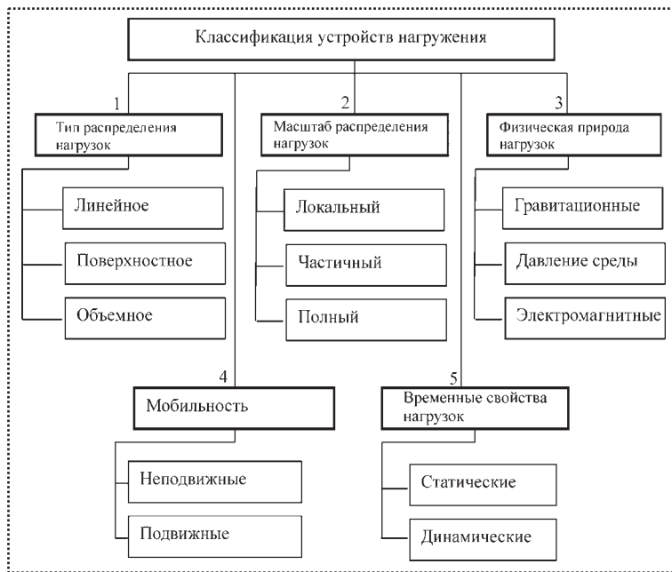
Рис. 1. Многоаспектная классификация устройства нагружения
