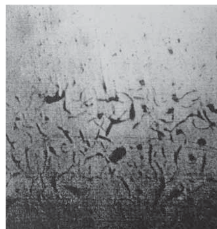
Рис. 2. Окисленный слой на не травленном шлифе
