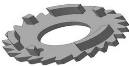
Рис. 4. Деталь точной механики типа «храповик»
