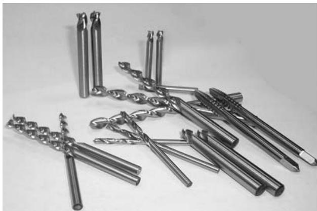
**Рис. 7. Режущий инструмент из биметаллических материалов**
