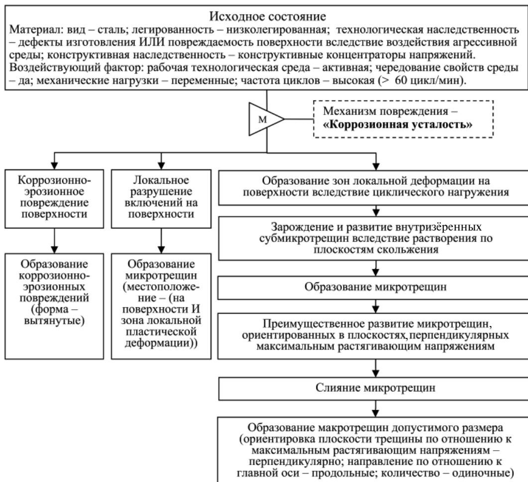
Рис. 7. Пример дерева событий нежелательного процесса «Коррозионное растрескивание», стадия повреждения
