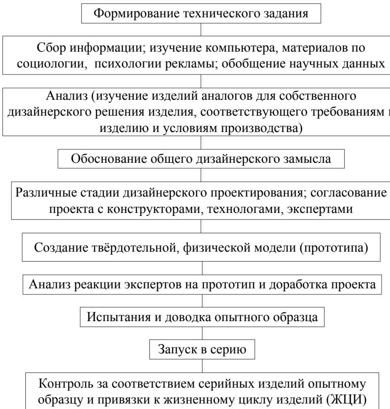
**Рис. 3. Алгоритм дизайнера проектирования и запуска изделия в производство**
