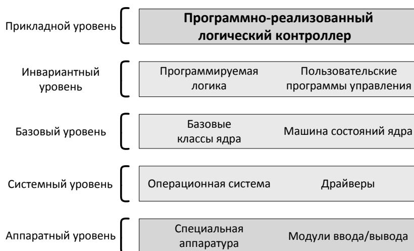
Рис. 1. Виртуальная модель Soft PLC
