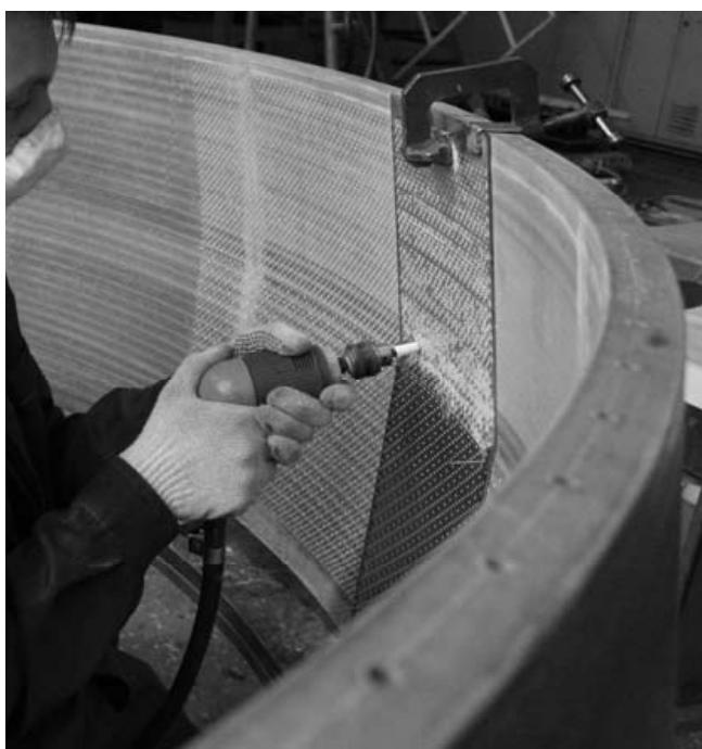
**Рис. 3. Ручная перфорация звукопоглощающей панели**
