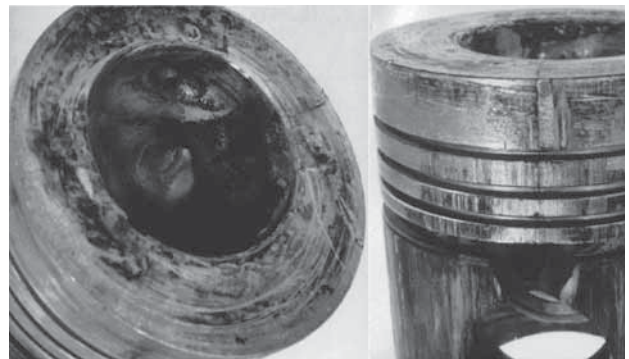
Рис. 1. Трещина на днище и кромке камеры сгорания поршня с "задирами" и разрушением бобышек поршня
