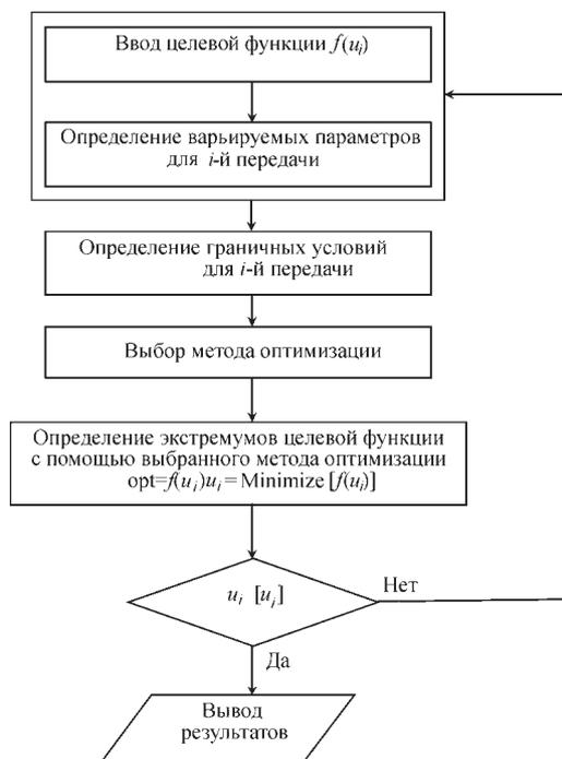
Рис. 4. Блок-схема алгоритма оптимизации передаточных чисел трансмиссии
