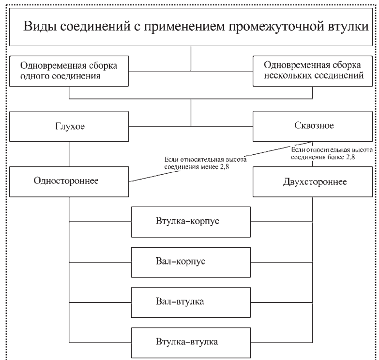
Рис. 2. Классификация соединений с применением промежуточной втулки
