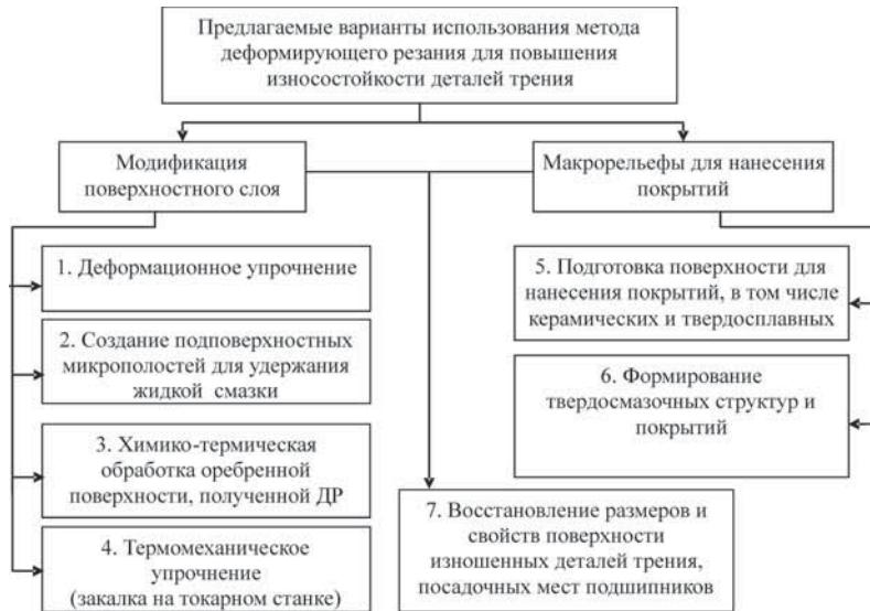
Рис. 2. Варианты использования метода ДР для повышения износостойкости деталей трения
