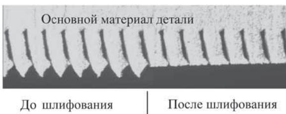
Рис. 7. Профиль подповерхностных полостей, полученных инструментом для ДР на стали 38Х2МЮА
