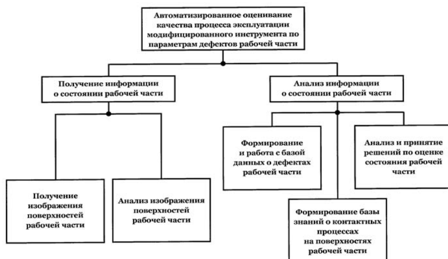
Рис. 1. Общий подход к автоматизированному оцениванию качества процесса эксплуатации модифицированного металлорежущего инструмента по параметрам дефектов рабочей части
