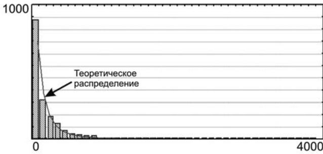
Рис. 3. Распределение длин заготовок из листа (углеродистая сталь) предприятия ОАО "Станкотехника" г. Тула (трёхлетняя программа выпуска): тест Колмогорова–Смирнова ( d = 0,370597 при p < 0,05 ); параметры распределения ( \sigma = 1,20549 ; \mu = 4,27423 )
