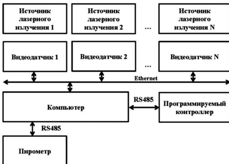
Рис. 3. Функциональная схема программно-аппаратного комплекса
