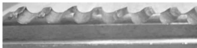
Рис. 1. Фрагмент шпоночной протяжки с выкрошенными зубьями
