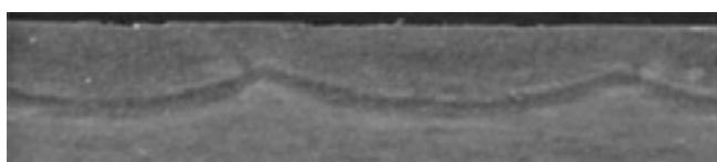
Рис. 6. Структура дорожки упрочнения, полученная сфокусированным лучом лазера МКТЛ-3
