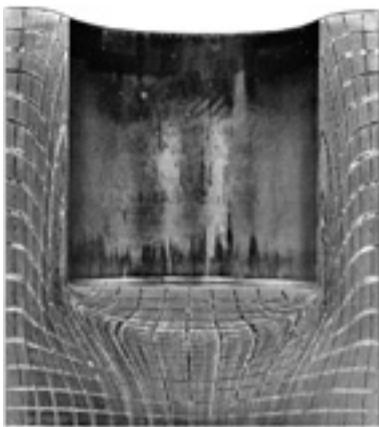
Рис. 3. Искажение делительных сеток при обратном выдавливании цилиндрического стакана
