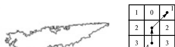
Рис. 5. Пример анализа окрестностей текущей точки контура износа для оценки гладкости
