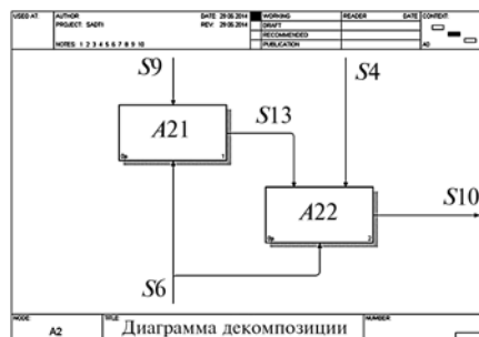
Рис. 4. Диаграмма декомпозиции уровня 2: A11—A33 — функциональные блоки; S1—S15 — интерфейсные дуги
