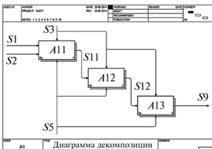
Рис. 4. Диаграмма декомпозиции уровня 2: A11—A33 — функциональные блоки; S1—S15 — интерфейсные дуги
