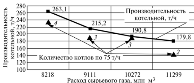
Рис. 6. Режимы работы котельной при переменной нагрузке по УВС
