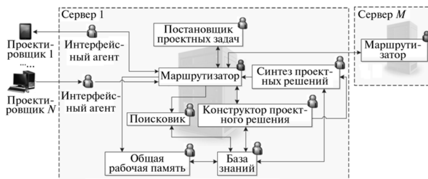
Рис. 1. Структура многоагентной системы распределённого проектирования
