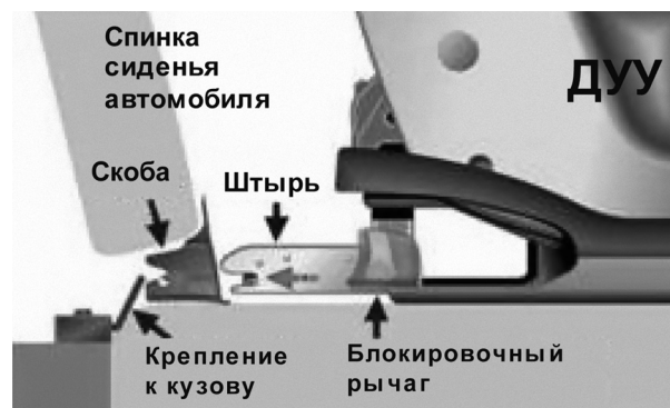
Рис. 5. Крепление ДУУ к кузову автомобиля
