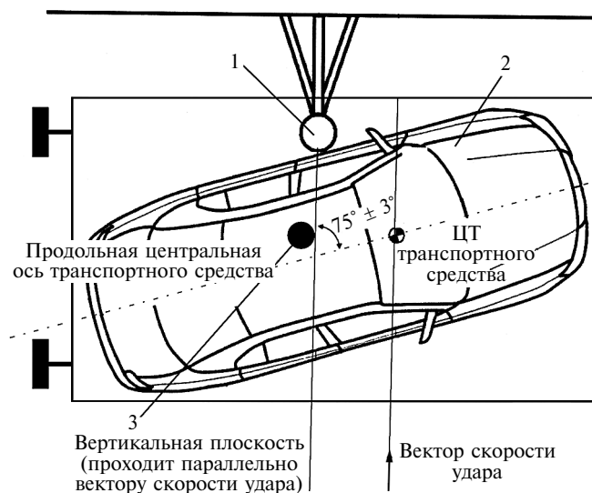
Рис. 10. Испытание автомобиля на боковой удар о столб в соответствии с ГТП № 14 ЕЭК ООН:
