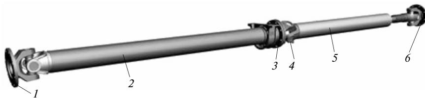
Рис. 1. Конструкция карданной передачи автобуса "Волгабус Ритмикс":
