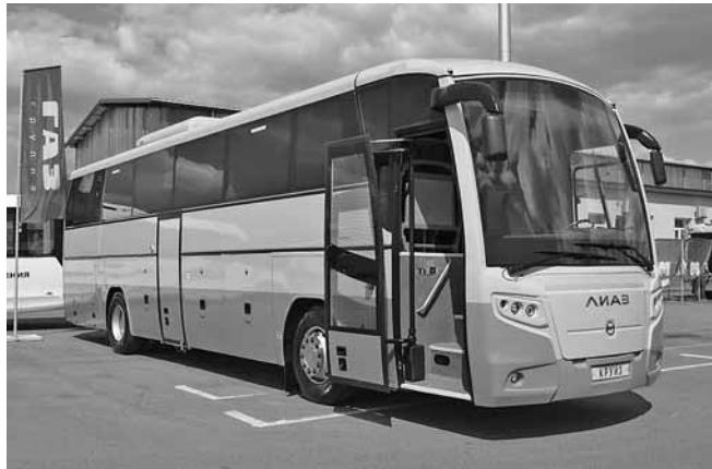
багажных отсеков (10 куб. м), электронная система управления подвеской с функцией подъема и опускания кузова для преодоления сложных участков дороги, индивидуальные сервис-блоки для пассажиров обеспечивают комфорт при дальних перевозках.
