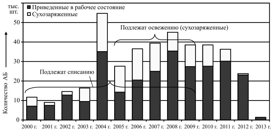
Рис. 2. Распределение аккумуляторных батарей по годам выпуска и по состоянию в 2014 г.
