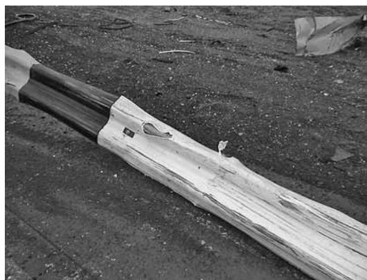
Рис. 3. Повреждения пластикового ограждения после наезда автомобиля
