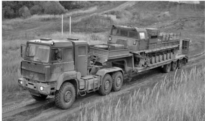
Рис. 3. Преодоление автопоездом уклона в  $11^{\circ}$
