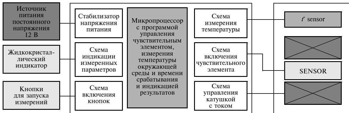
Рис. 5. Структурная схема экспериментальной установки
