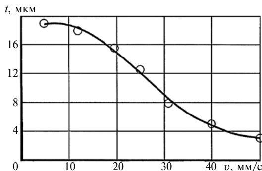
Рис. 5. Зависимость высоты t трека от скорости v лазерного луча
