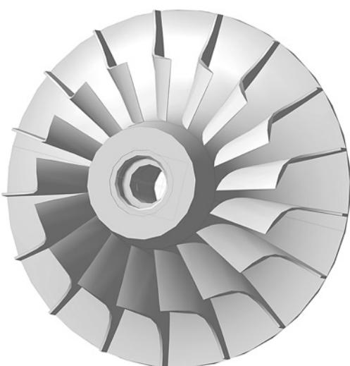
Рис. 6. Окончательная конструкция РК
